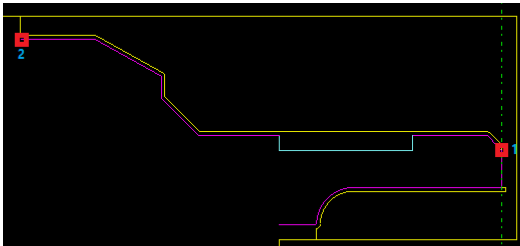
Figura 12.24 Selectarea traiectoriei pentru strunjirea de finisare pe conturul exterior
